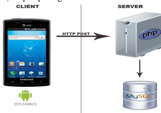
Gambar 7 Skema Android-PHP-MySQL menggunakan JSON
